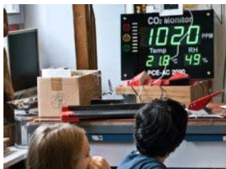
Eine CO2-Ampel in einer Pankower Schule: Über 1000 ppm drohen Schwindel und Kopfschmerzen. Da hilft nur rechtzeitiges und intensives Lüften. Foto: Stratum GmbH für „Köpfchen statt Kohle“
